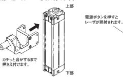
(4) 対向する受光器(または投光器)の上部中心付近にレーザ光が照射されるよう 粗調整を行います。調整後、上部の取付金具を仮固定します。
