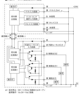
■外部リレーモニタ機能を無効にする配線 外部リレーモニタ入力を補助出力へ短絡してください。
