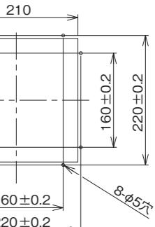
取付穴寸法/パネルカット寸法
