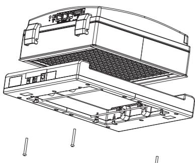
残りの取り付け穴 4箇所にナットを挿入してください。
