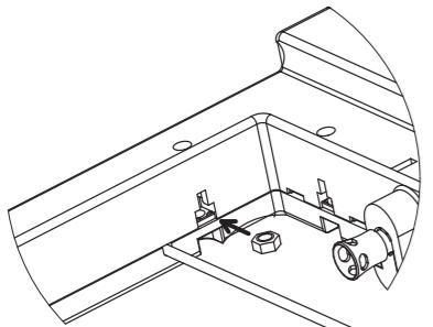
付属ねじ M4×35 を 4 本使用し、締め付けトルク 1.2 ~ 1.6N.m で取り付けてください。
